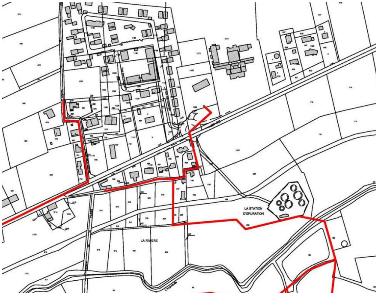
Extrait du plan du réseau d'eaux usées
