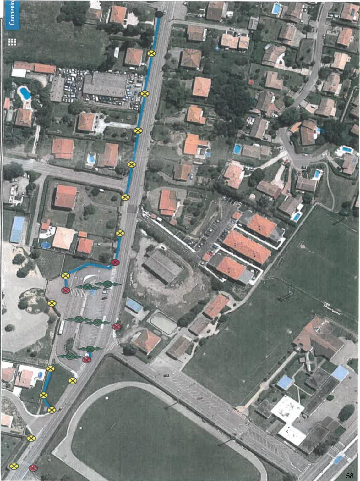
— réseau souterrain d'éclairage public à construire en conducteur U1000RO2V.
