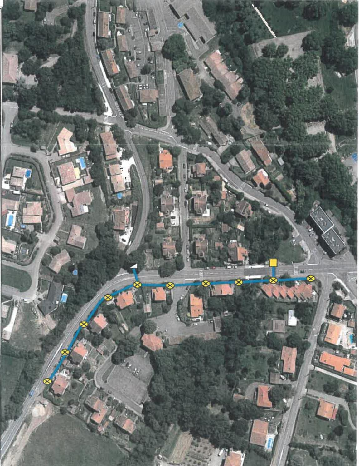
— réseau souterrain d'éclairage public à construire en conducteur U1000RO2V.
